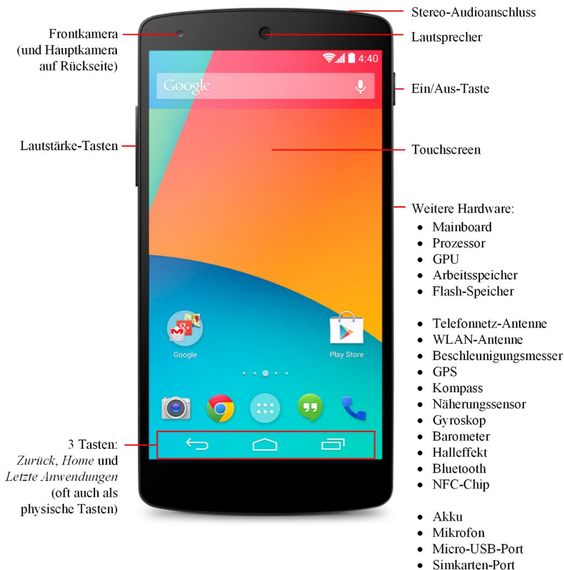
**Abbildung 1: Typische Hardware-Komponenten eines Android-Smartphones am Beispiel des Nexus 5**
